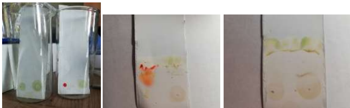
Рис. 8. Определение качественного состава пигментов с использованием неполярного растворителя
