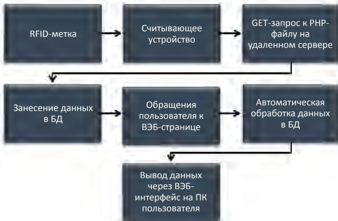
**Рис. 3.** Алгоритм работы программно-аппаратного комплекса цифровой идентификации поголовья
